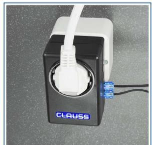
7. Nachdem erstmals Warmwasser angefordert wurde, oder schon vorher, sollte die LED grün-orange blinken und die Zirkulationspumpe für ca. 20 min laufen. Die Laufhäufigkeit und -dauer ist in den ersten 7 Tagen nach Inbetriebnahme erhöht, weil automatische Optimierungsvorgänge stattfinden.
